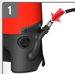
Schlauch an Windkessel schrauben
